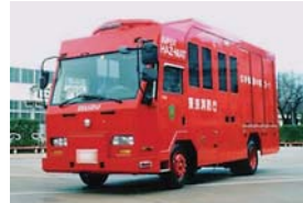
特殊災害対応自動車 (核物質・生物剤・化学剤に起因するNBC災害に対応可能な車両)
